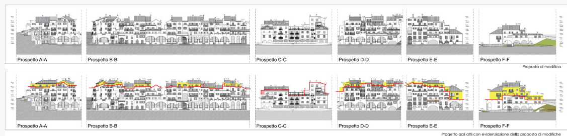
Figura 1 – Prospetti dell'intervento: proposta di modifica (sopra), e progetto agli atti con evidenziazione della proposta di modifica (sotto). In giallo le modifiche in riduzione, la linea rossa indica l'altezza della linea di gronda della possibile modifica
